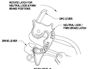
FIGURE 9 NEUTRAL LOCK/PARK BRAKE LATCH
